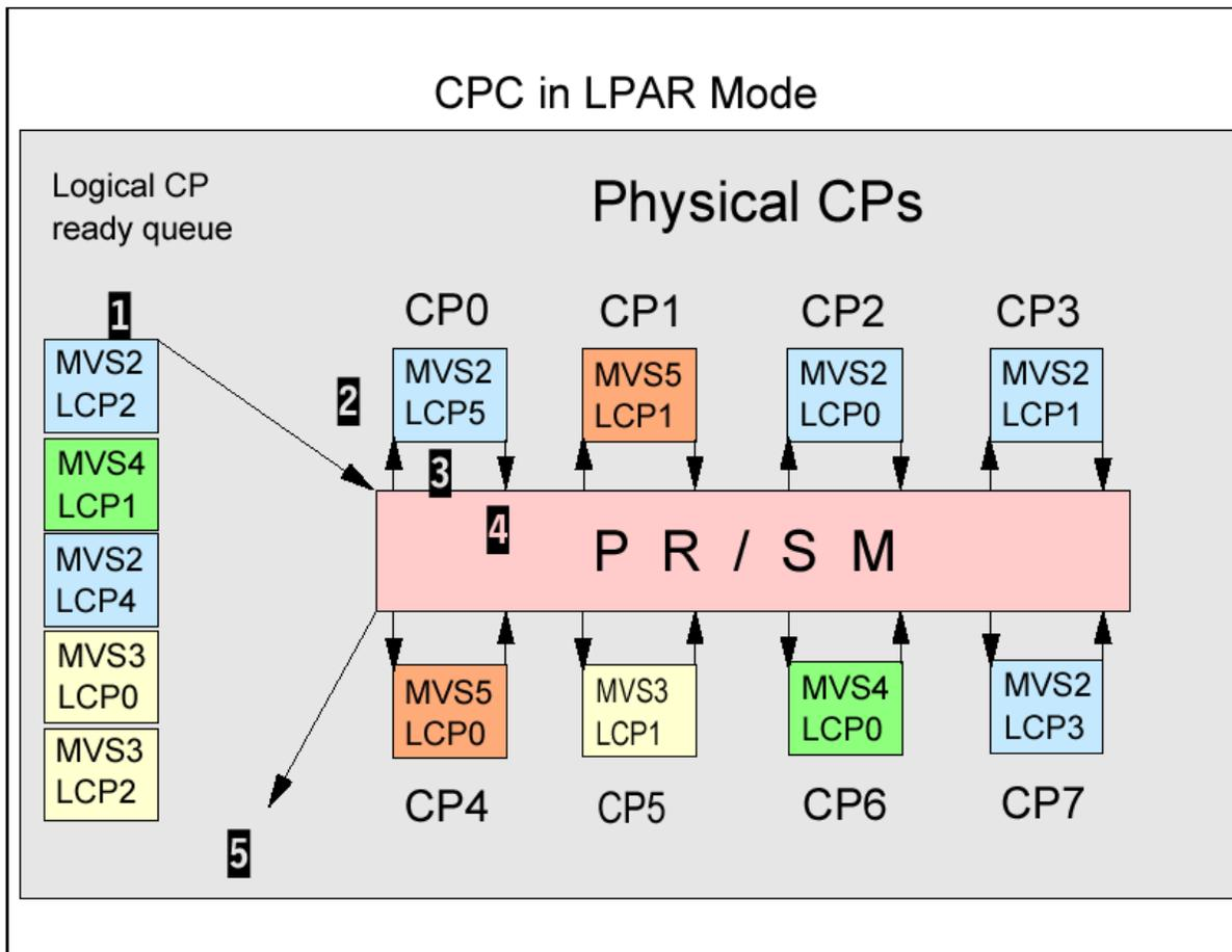
Den vier LPARs mit den Betriebssystemen MVS2, MVS3, MVS4 und MVS5 stehen 8 physische CPs (CPUs) zur Verfügung (CP0 .. CP7).
