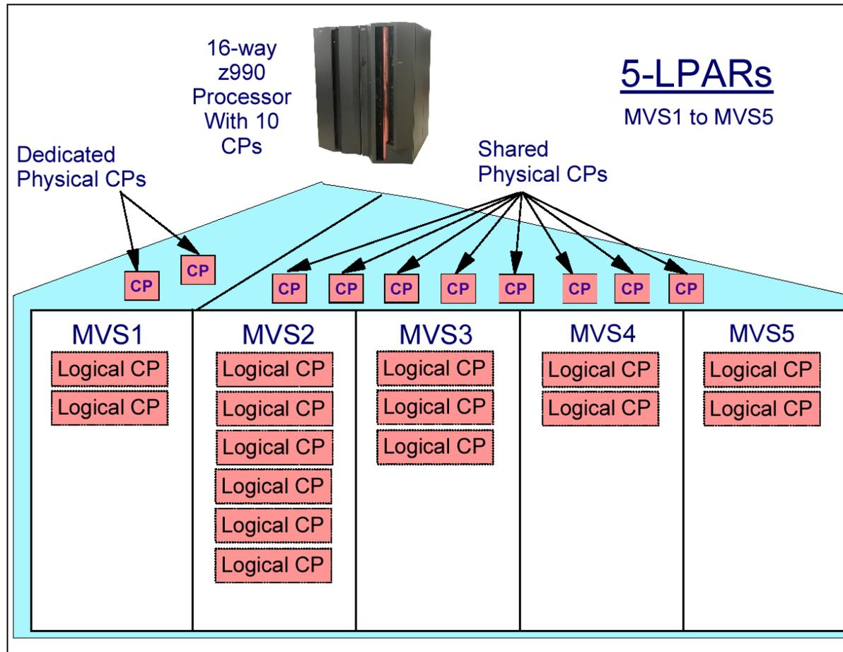
Physische CPUs (CPs) können einer bestimmten LPAR fest zugeordnet, oder von mehreren LPARs gemeinsam genutzt (shared) werden. Bei einer LPAR mit fest zugeordneten CPUs ist eine logische CPU permanent einer physischen CPU zugeordnet. Dies bedeutet weniger Overhead.
