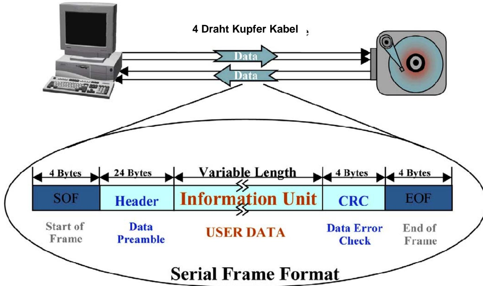
Die ursprünglich parallel übertragenen OEMI oder SCSI Daten werden bei SAS (serial attached SCSI) in einen Rahmen (Frame) gepackt und über ein Kupferkabel seriell übertragen. Die Fibre Channel SCSI (FC-SCSI) Version verwendet statt dessen zwei Glasfaserkabel (für Hin- und Rückleitung).
