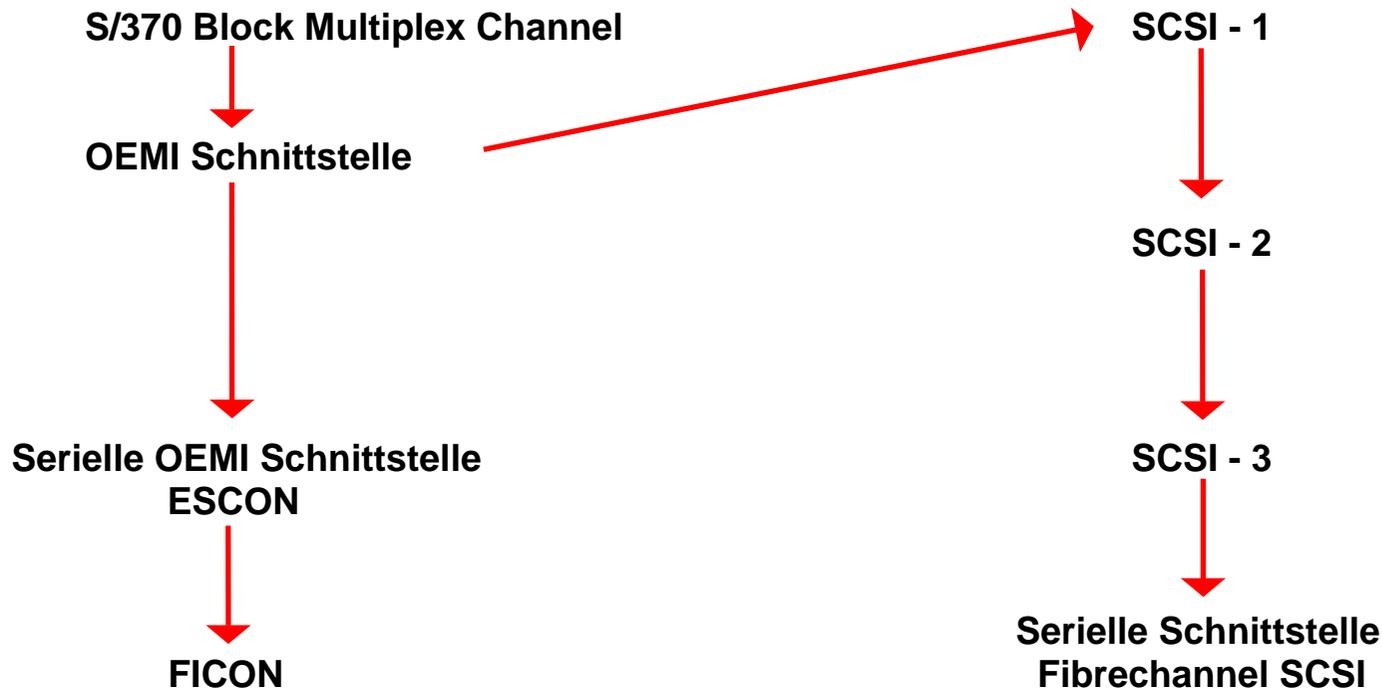
Für den Anschluss von I/O Geräten System führte das Sytem/360 im Jahre 1964 den „Selektor“ und 1970 den „Block Multiplex“ Kanal ein. IBM veröffentlichte diese I/O Schnittstelle unter dem Namen OEMI (Original Equipment Manufacturer Interface) , was dazu führte, dass viele unabhängige Hersteller I/O Geräte für den Anschluss an die damaligen Mainframes entwickelten und installierten. Das ist auch heute noch der Fall.
