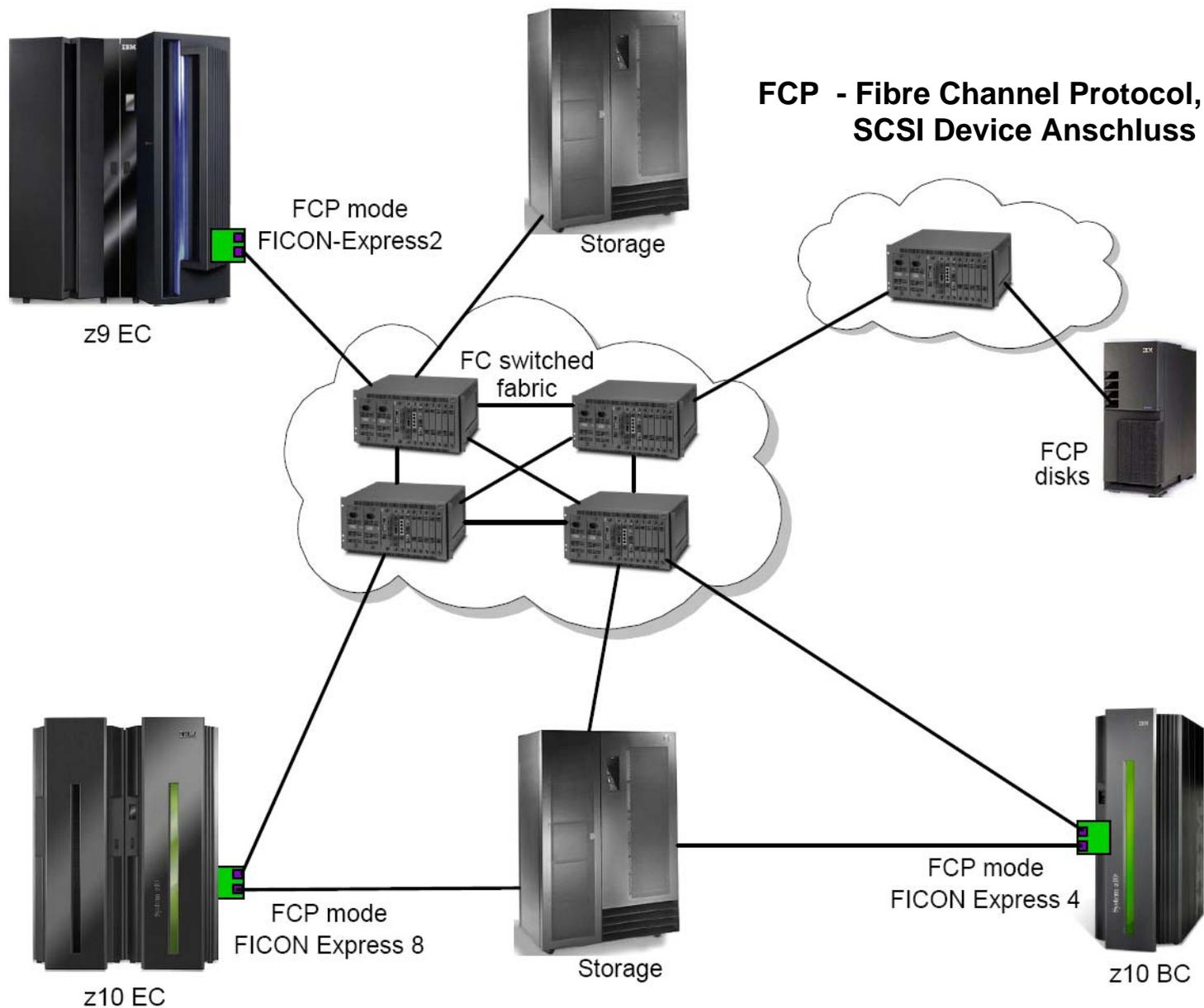
**Heutige Mainframes können alternativ neben FICON Plattenspeichern auch Fibre Channel SCSI Plattenspeicher anschließen. Dies ist z.B. beim Einsatz von zLinux üblich. Der Großteil der Daten einer Mainframe Installation wird aber auf FICON Platten gespeichert.**
