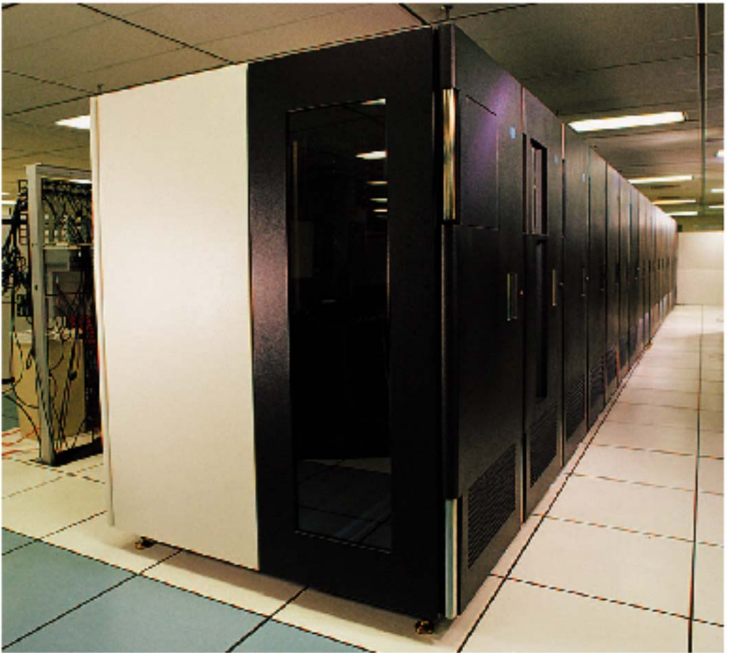
Abb. 5.4.8 Ansicht der IBM 3494 Tape Library
