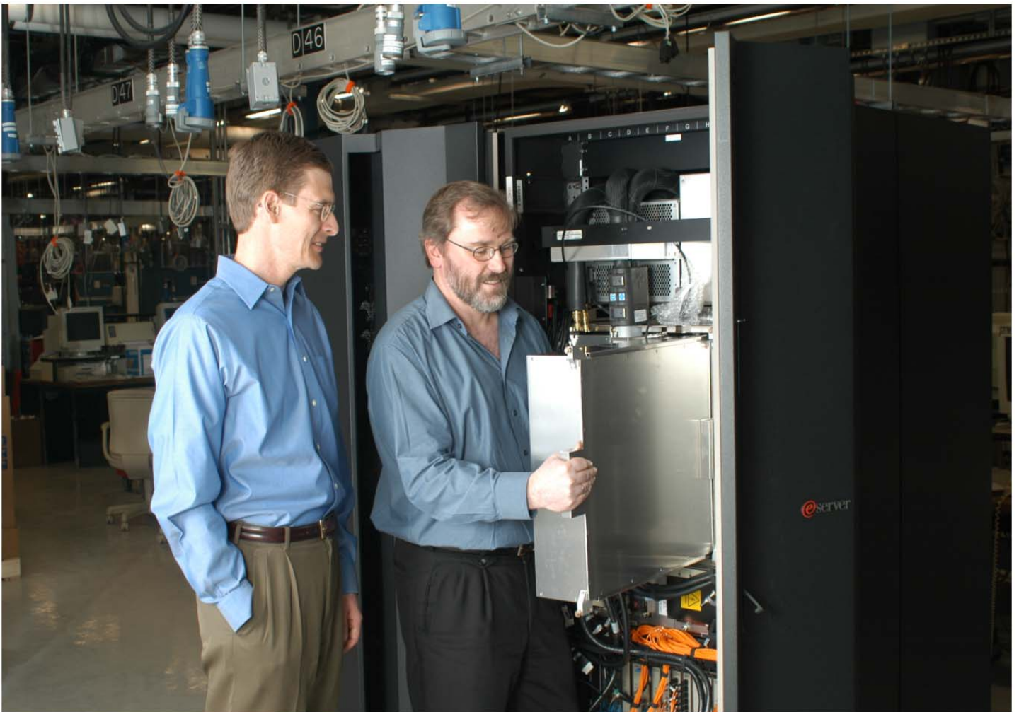
Abb. 4.3.5 Hier entfernt ein Entwicklungsingenieur ein Book aus einem z9 Rechner.
